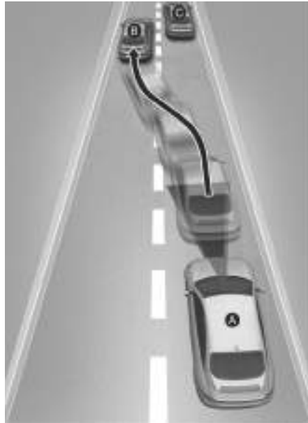
[A] Vaše vozidlo [B] Vozidlo přejíždějící do jiného jízdního pruhu [C] Vozidlo ve stejném jízdním pruhu
