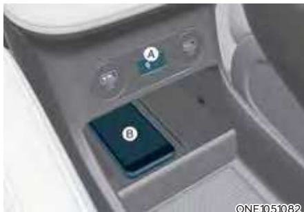
[A]: Kontrolka, [B]: Nabíjecí podložka
